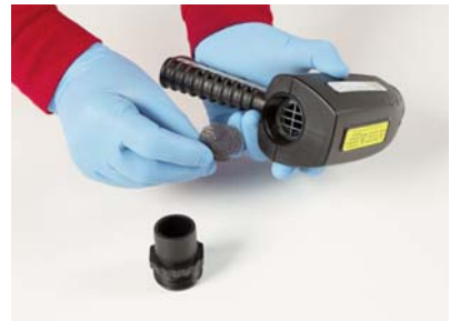
Sustitución del filtro
