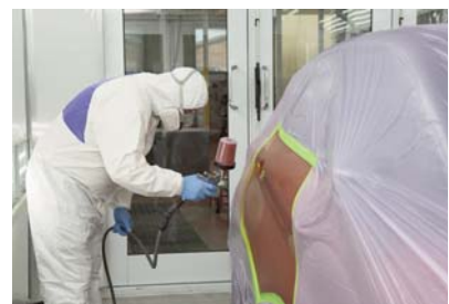
Aplicación aerográfica de la pintura
