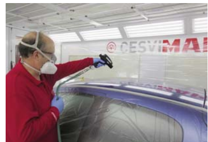
Proceso de ionización del aire
