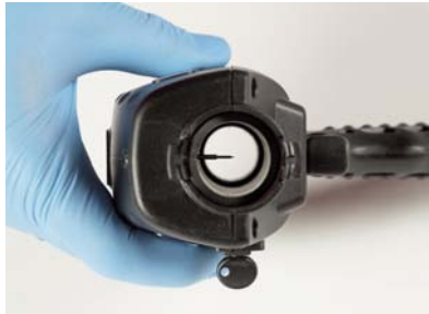
Retirar y colocar el pin emisor
