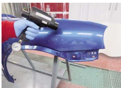
Ionización sobre la pieza de chapa
