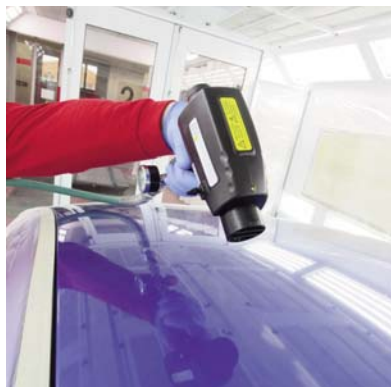
LED verde: sistema de ionizado activado
