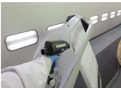
Ionizado sobre pieza plástica
