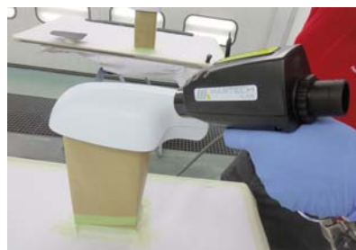
Ionizando una tapa de espejo
